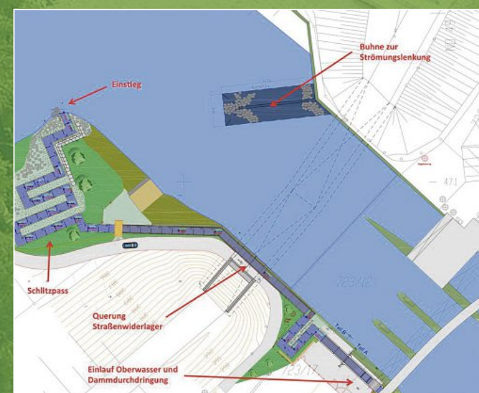
Elemente der Fischwanderhilfe Pulling.
